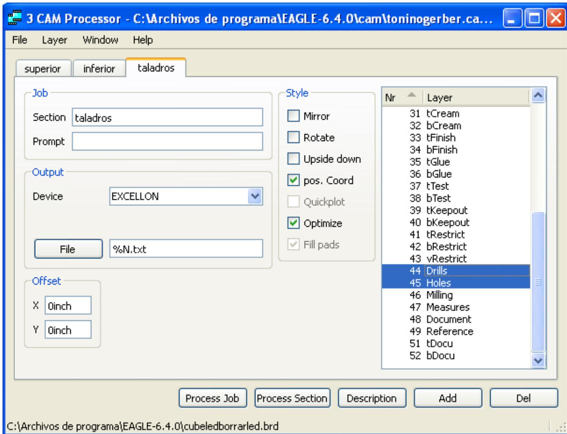
En esta seleccionamos output- Excellon, le ponemos la extensión .TXT y en este caso seleccionamos las Layers Drills, Holes.
