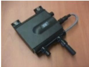
CB155 PROFIBUS con conector T y Terminales
