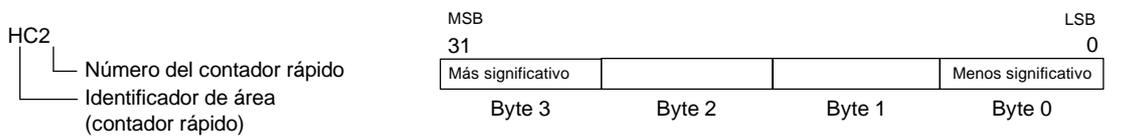
Figura 6-28 Acceso a los valores actuales del contador rápido
