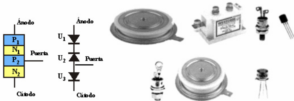
Fig 5.3 Modelo de Tiristor: Cuatro capas. Tres diodos. Distintos tipos de encapsulado para el tiristor
