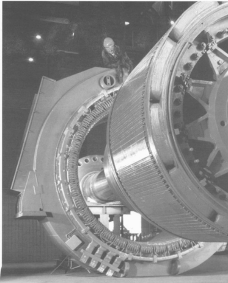
Motor síncrono de velocidad regulable a través de una alimentación por ciclo-convertidor.
