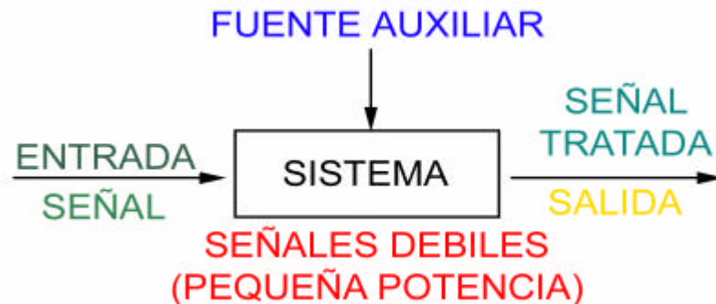
Fig 0.3 Característica fundamental de un sistema electrónico de Señal
