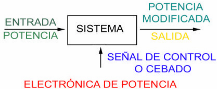
Fig 0.4 Característica fundamental de un sistema electrónico de Potencia
