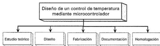
Figura 12.1. Obtención de las tareas en las que se puede dividir un proyecto mediante una estructura WBS.
